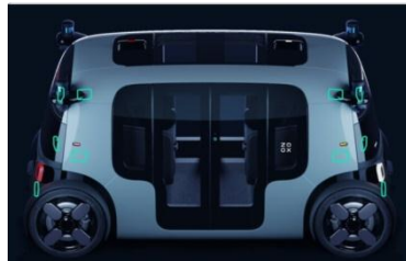
Hệ thống Radar (5 radar/ góc, tổng: 20 Radar)
