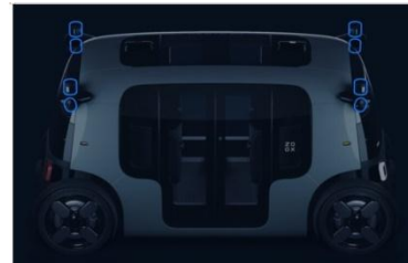
Hệ thống Lidar (4 radar/ góc, tổng: 16 Lidar)
