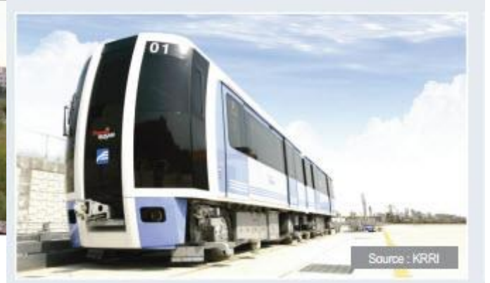
Hệ thống trung chuyển bằng ray hạn nhẹ của Hàn Quốc với tốc độ max 70 km/h với sức chứa 100 người trên cơ sở ứng dụng công nghệ sạc không dây của KAIST.
